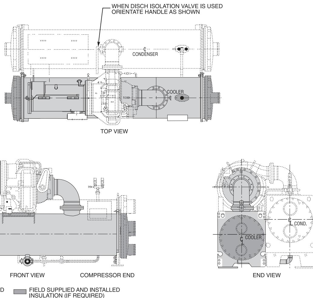
**19XR,XRV FACTORY-INSTALLED INSULATION AREA (cont)**
